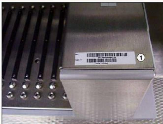
Figura 1-7: Plataforma de carregamento - etiqueta de artigo e número de série
