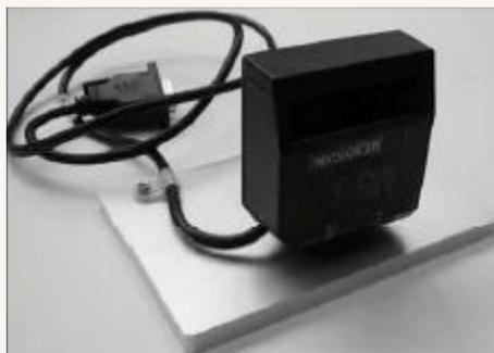
Figura 2-9: Leitora de código de barras de microplacas
